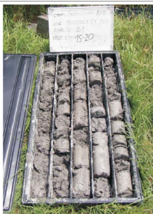
Cassa n°4 del sondaggio a carotaggio continuo S1 (15,00 - 20,00 metri)
